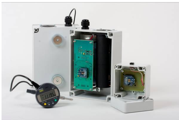
Obrázek 1 : Kompletní sestava měřicího řetězce
