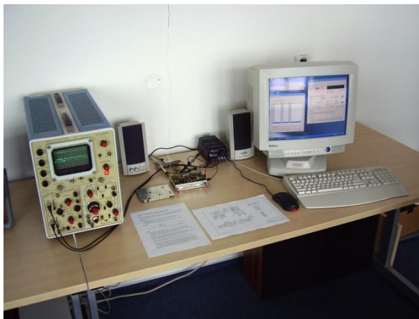
Sestavená laboratorní úloha využívající vzorek (kovová skříňka uprostřed)
