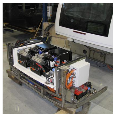
Obrázek 4 Proterra ProDrive system.
