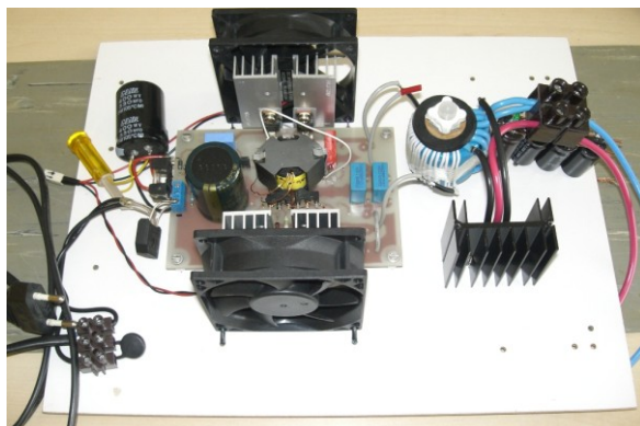
Obr. 1 Sestava měniče s přidavným aktivním chlazením
