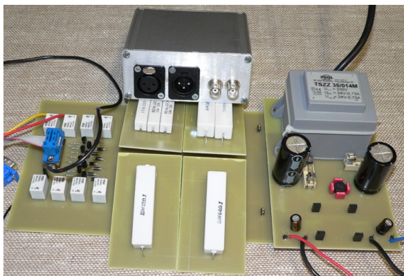
Funkční vzorek adaptéru pro měření parametrů nízkošumových stabilizátorů
