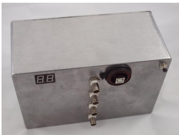
Obr. 1: Čelní panel modulu s ovládacími prvky a konektory pro připojení RLC můstku.
