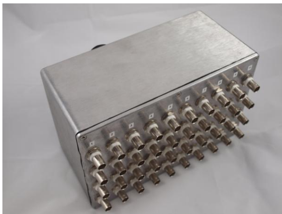
Obr. 2: Zadní panel modulu s deseti výstupními kanály.
