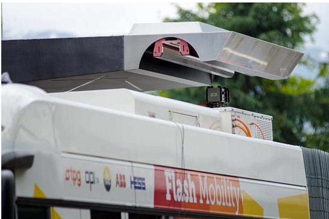
Obr.16 Obrázek 12 Nabíjecí hlavice systému TOSA [21]
