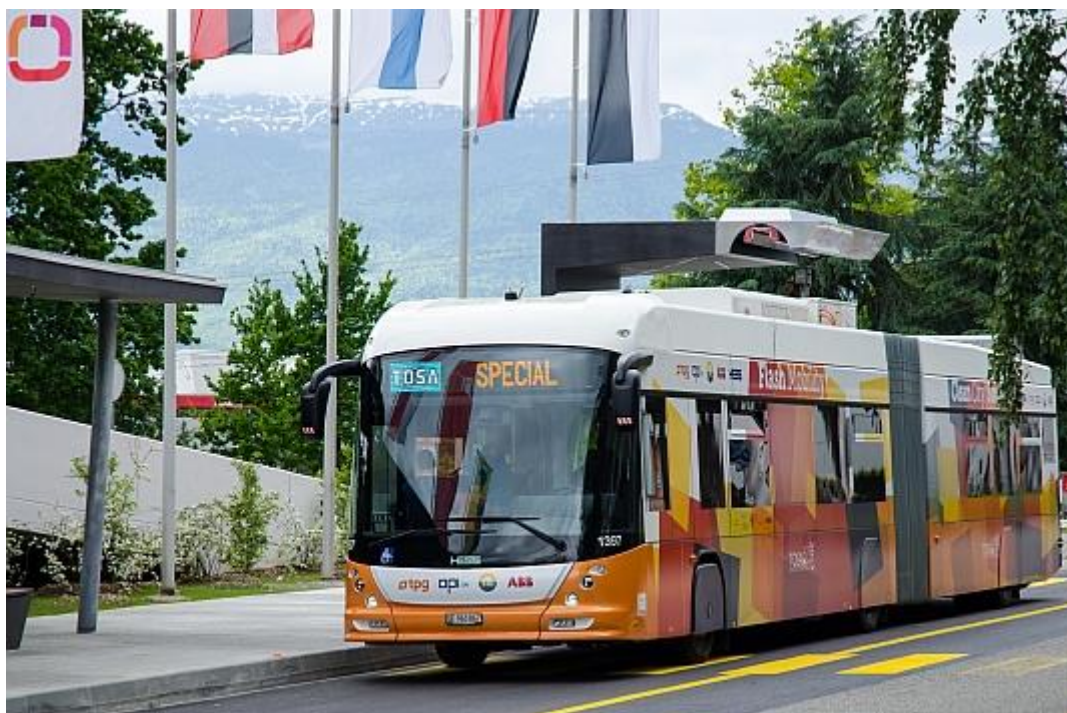
Obr.15 Elektrobus Hess vybavený nabíjecím systémem TOSA [20]
