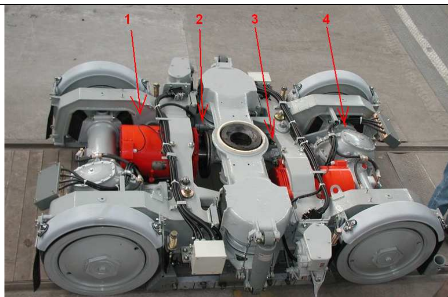
Obr.5.2a) Podvozek „Komfort“ (výrobce Pragoimex ) pro modernizaci vozidel T3 atd. Průměr kol 700mm. Trakční motor 1, kotoučová brzda 2, pod odpruženou kolébkou vede kloubový hřídel 3 (s podélnou osou – tj. kolmo k nápravě), na nápravě převodovka 4. Bližší popis viz např. kap. 4.1.2 v [2]. Upraveno a převzato z [E164]
