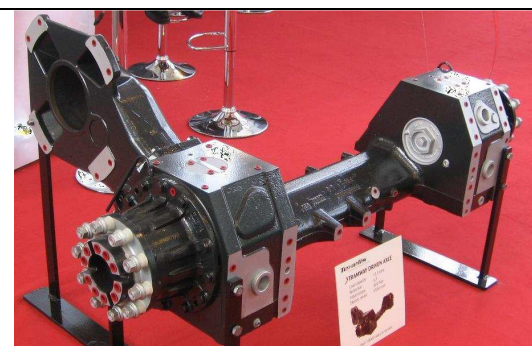
Obr.5.5.3b) Nápravnice (dole), převodovky a náboje pro připojení kol (dole uprostřed), příruba k připevnění motoru (vlevo nahoře) tramvaje Citadis . Převzato z materiálu [E158].
