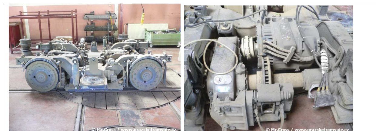
Obr.5.1c Neotočný podvozek částečně nízkopodlažní tramvaje 14T výrobce Škoda . Průměr kol 610mm, 50% nízké podlahy, nástup do nízkopodlažních částí vozu 350mm (tj. větší nástupní výška jen u prvních a posledních dveří). Na prvních dvou obrázcích (str.35) jsou pro srovnání v pozadí původní podvozky z tramvají T3 (viz kap. 5.2). Převzato z [E167]
