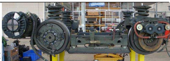
Obr.5.5.3c) Trakční podvozek vozidla Citadis – zcela vpravo motor, dole nápravnice, zcela vlevo je vidět pojezdové kolo a kotoučová brzda, pohled zprava na tuto situaci - viz obr.5.5.3e. Převzato z [E198].
