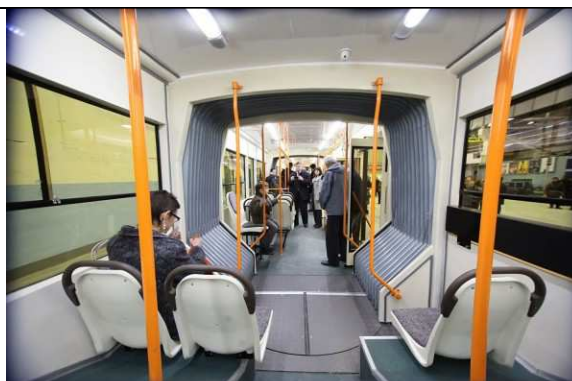
Obr.5.7.1g Interiér vozu v místě zadního kloubu-pohled vpřed [E57]
