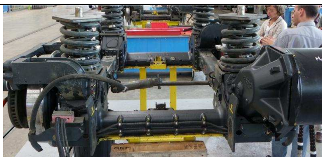
Obr.5.5.3c) Trakční podvozek vozidla Citadis – zcela vpravo motor, dole nápravnice, zcela vlevo je vidět pojezdové kolo a kotoučová brzda, pohled zprava na tuto situaci - viz obr.5.5.3e. Převzato z [E198].
