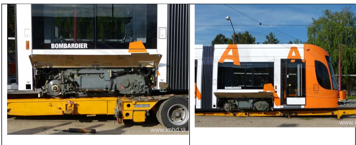
Obr.5.4c Tramvaj Flexity Outlook při přepravě do MHD Bratislava. Na nápravě vpravo je vidět převodovka, na nápravě vlevo kotoučová brzda, uprostřed motor. Převzato z [E43].
