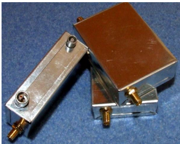
Finální konstrukce sady zesilovačů.
