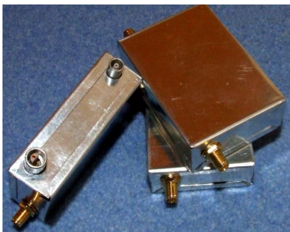
Finální konstrukce sady zesilovačů.
