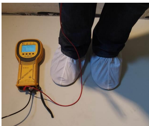
Měření systémové rezistance disipativní podlahy.
