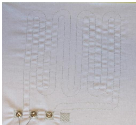
Senzorové a propojovací vodivé motivy vytvořené metodou našívání.
