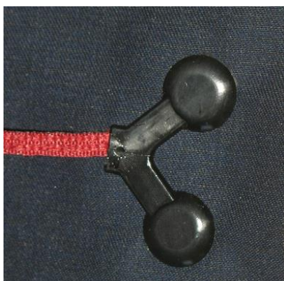
Rozebíratelné propojení sběrníkového systému vytvořené pomocí druků.
