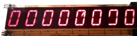
Vyrobený prototyp 16 segmentového LED displeje
