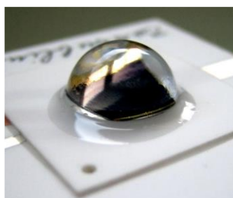
Sekundární koncentrátor na keramickém pouzdře CPV přijímače.
