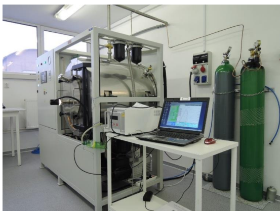
Pec CLASIC pro výpal měděných vrstev na korundových substrátech.
