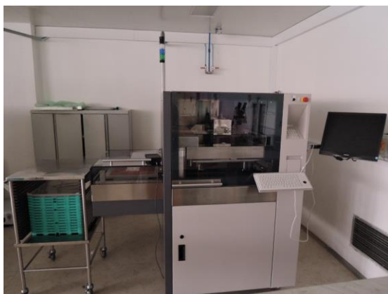
Sítotiskové zařízení EKRA XH – STS pro tisk měděných vrstev na korundových substrátech.
