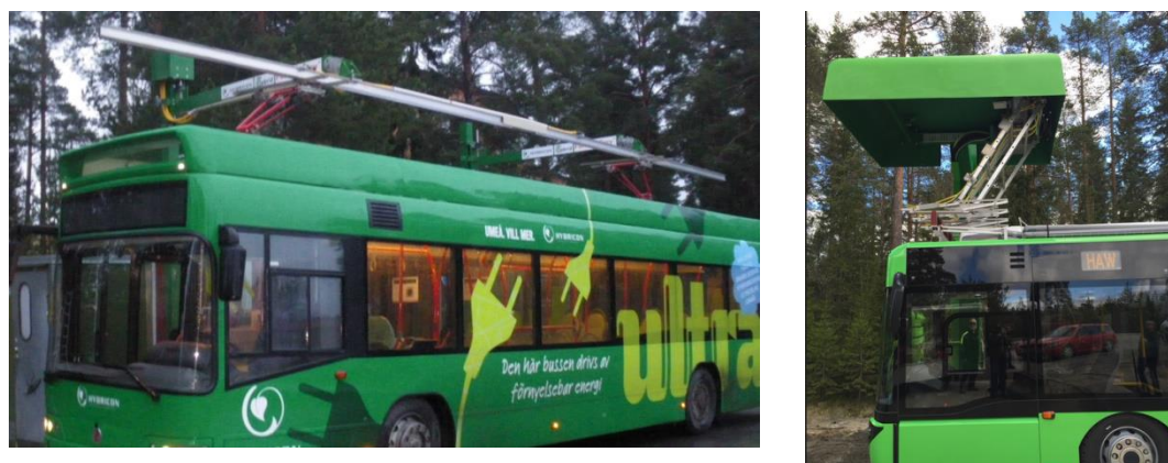
Obr. 3 - Nabíjecí stanice Opbrid Busbaar ve Švédsku [6], vpravo systém V3 s výkonem 650kW.
