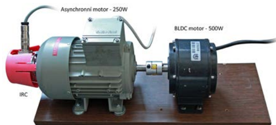
Obrázek I – Soustrojí s BLDC a zatěžovacím asynchronním motorem
