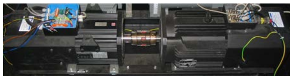
Obrázek I – Soustrojí s PMSM 10,7 kW a zatěžovacím asynchronním motorem
