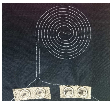
Flexibilní sensor teploty integrovaný v textilií.
