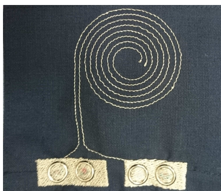
Flexibilní sensor vlhkosti integrovaný v textilií.
