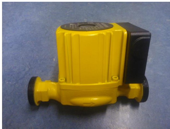
Obrázek I – Oběhové čerpadlo s řídicí jednotkou s implementovaným SW
