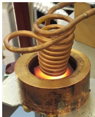
Obrázek V Ohřev grafitu v kalorimetru (při měření tepelných toků z grafitu do kalorimetru)
