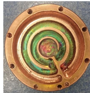
Obrázek IV Frézované chladicí kanály (meandr) kalorimetru
