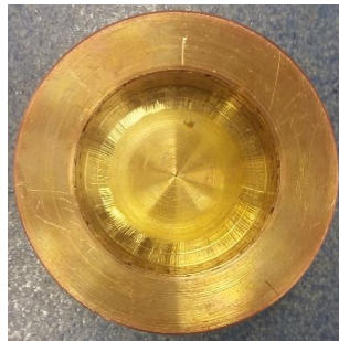
Obrázek III Vrchní část kalorimetru s pracovním prostorem
