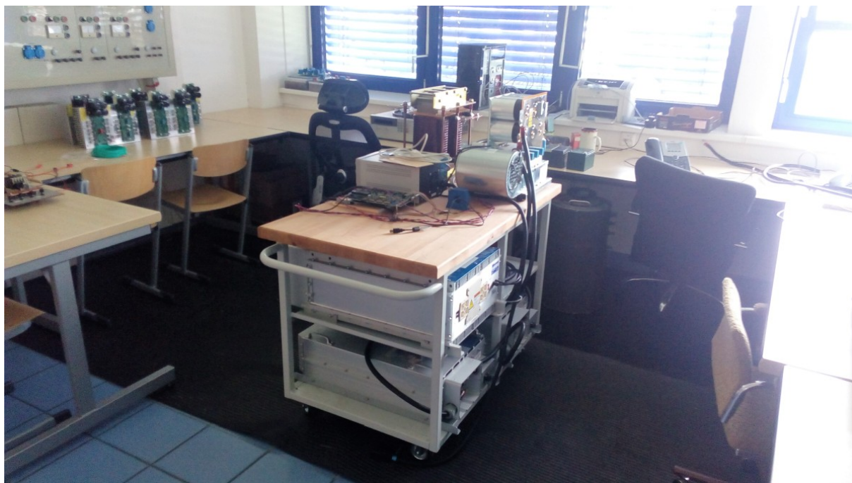
Obr. 3.10: Experimentální stand ESS systému sestávající se ze superkapacitorů MAXWELL a LSMtron
