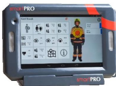
Obr. 2: Grafické rozhraní centrální řídicí jednotky CPU.
