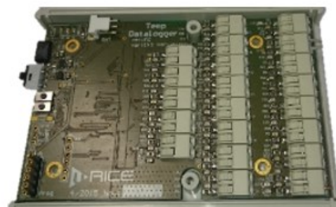
Obr. 3: Vyhodnocovací jednotka chytrého ochranného obleku s integrovaným systémem pro monitorování tepelné kapacity.
