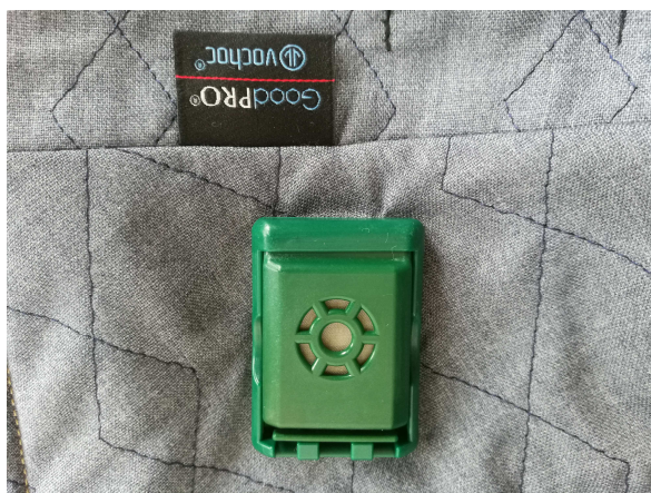
Obr. 2: Senzorový modul pro detekci relativní vlhkosti a teploty (umístěn v dockovací stanici)
