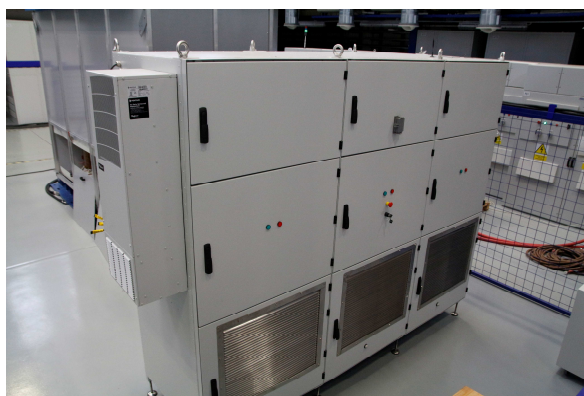
Obr. 1 Finální prototyp Zařízení pro kompenzaci zemních poruch
