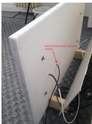
Obrázek II Sálavý panel s integrovaným senzorem Pt1000
