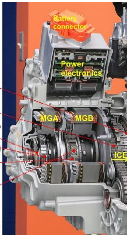
Obr. 39 Uspořádání pohonu Chevrolet Volta 2 generace [116]
