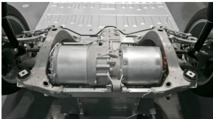
Obr. 61 Ukázka zadní nápravy Tesla model S [17]
