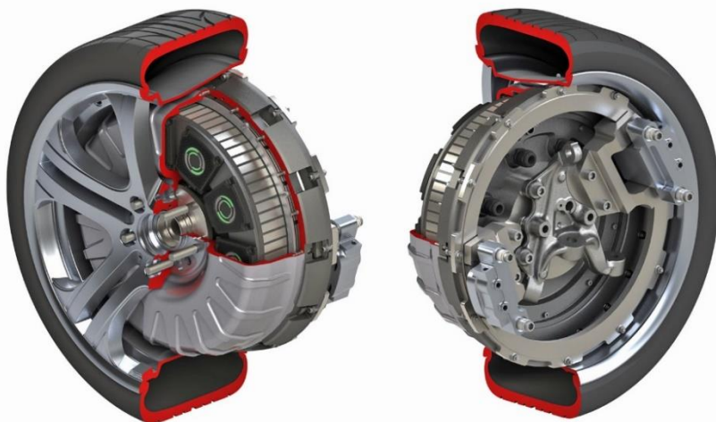
Obr. 78 Řez kola s pohonem Protean Electric [27]
