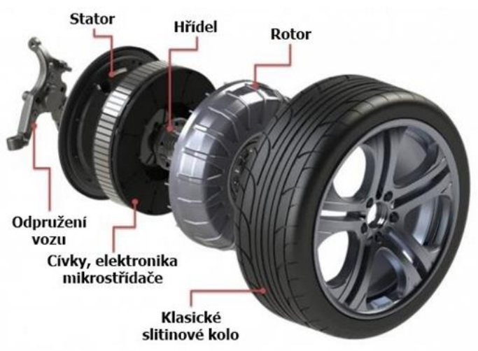
Obr. 76: Schéma motoru v kole [1]
