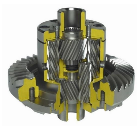
Obr. 63 Řez diferenciálu do elektromobilu Tesla S – přímá náhrada za originální diferenciál (QDH2T)[25]
