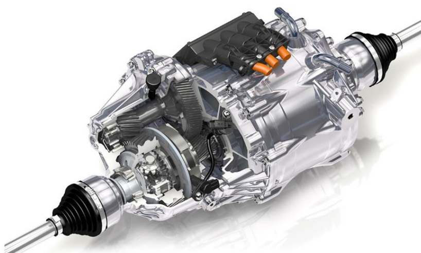
Obr. 24 Pohon zadní nápravy – integrovaná převodovka, diferenciál a motor v jednom pouzdře [63]
