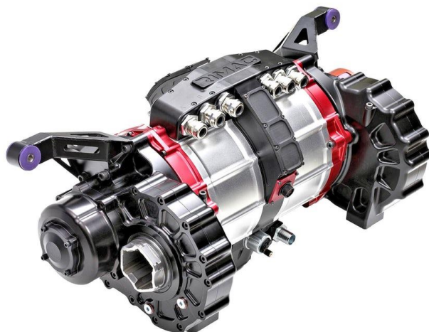
Obr. 85 Pohon přední nápravy Rimac Concept One [92]
