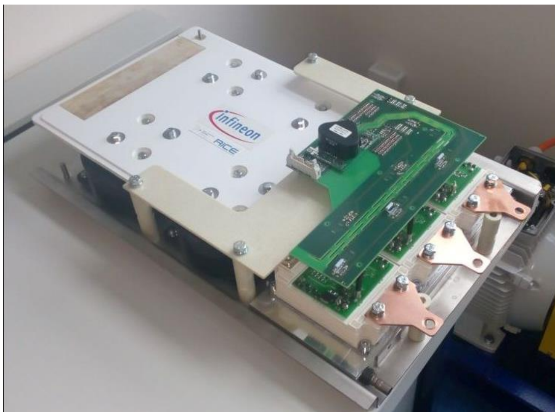
Obr. 6 Praktická realizace trakčního 3-fázového střídače
