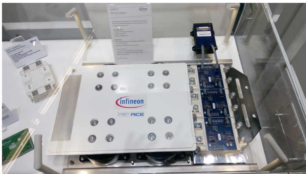
Obr. 3 Představení prototypu trakčního měniče s XHP moduly na veletrhu PCIM 05/2016
