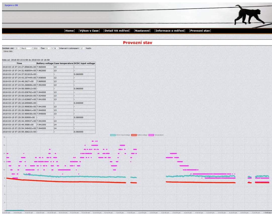
Obr. 20 Záznam provozního stavu měřicí platformy v delším časovém období pro výstupní napětí transformátoru, napětí záložní baterie a teploty
