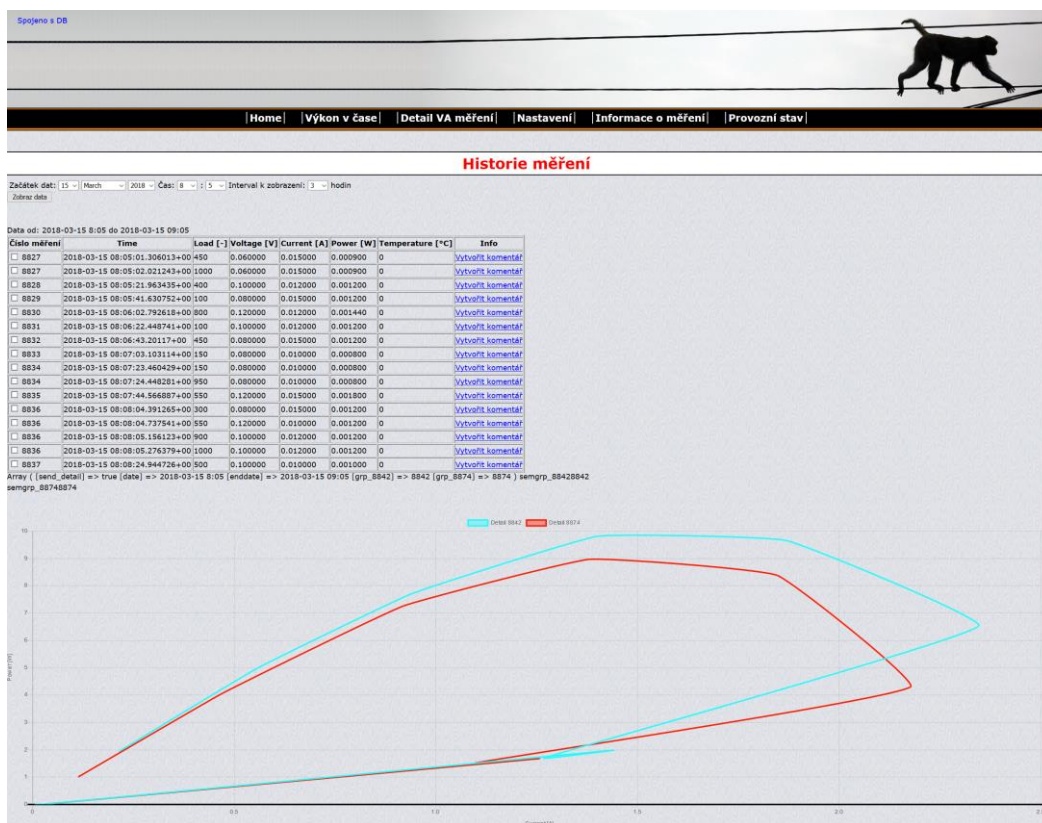
Obr. 18 Graf z testování zatížitelnosti vedení a dosaženého maximálního výstupního výkonu pomocí změny hodnoty výstupního proudu transformátoru
