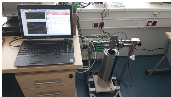
Obr.1: Stand pro měření teplotní dilatace
