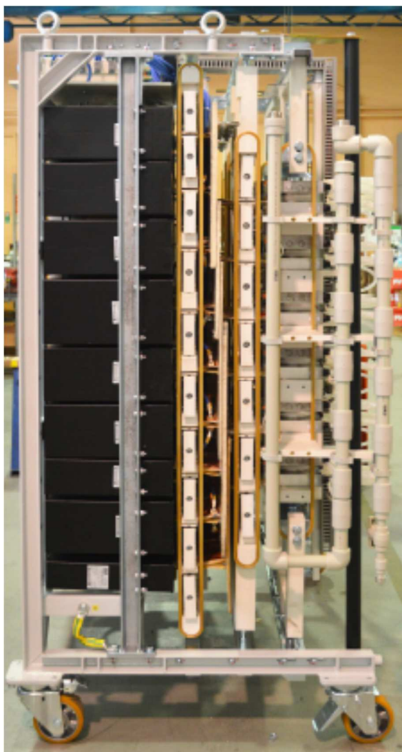
Obrázek 1 – Detail výkonové jednotky měniče (kondenzátory - sloupec s IGBT a část vodního chlazení)
