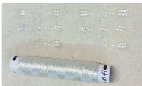
Obr. 1: Ultrazvukově svařitelná elektricky vodivá hybridní šicí nit s našitými vodivými strukturami pro vodivé struktury.
