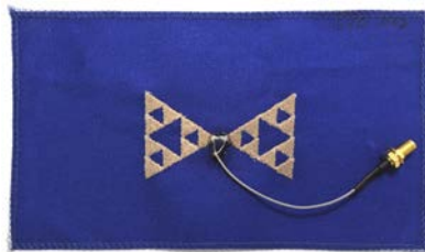
Motýlková anténa na textilní bázi pro pásmo 868 MHz.
