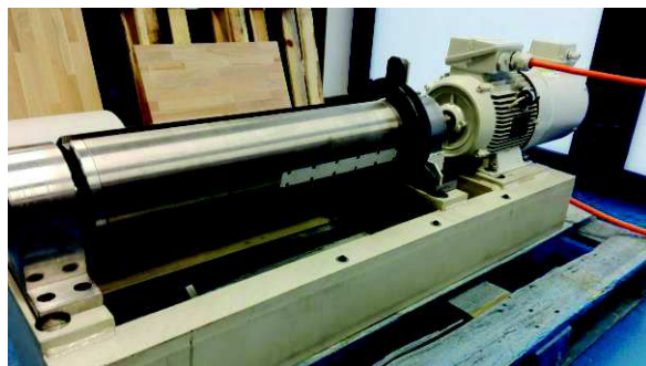
Obr.1: Testovací přípravek – část vřetene stroje
