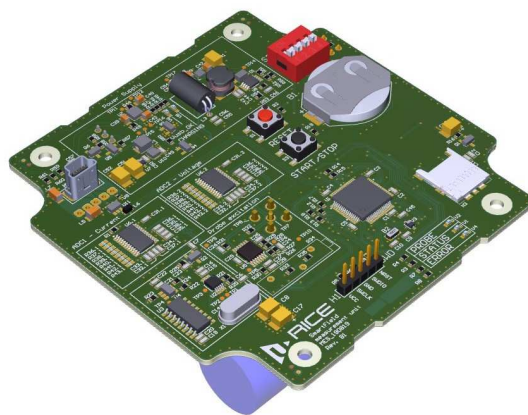
Obr. 3 Deska plošných spojů elektronické vyhodnocovací jednotky s bateriovým napájením.
