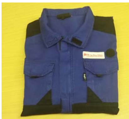
Pracovní oděv s našitým textilním senzorem pro detekci předepsaného režimu údržby.
