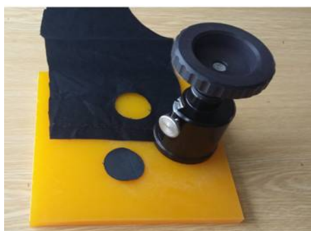
Kruhový senzor z textilie BA/PES TAURUS upravené polypyrrolem.
