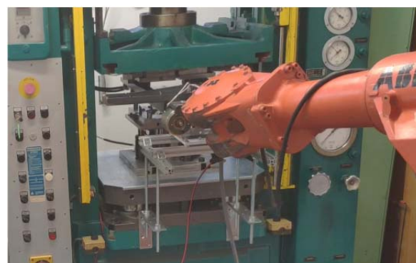
Robotizované pracoviště s hlubokotažným nástrojem umístěným v hydraulickém lisu, chladicím systémem a robotickým chapadlem
