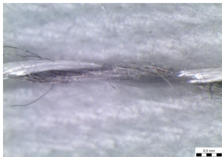
Nit' na bázi kovových vláken pro senzory namáhání v tahu.
