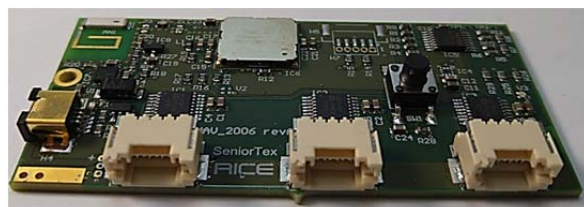
Obr. 3: Realizované desky plošných spojů pro chytrý návlek SeniorTex.
