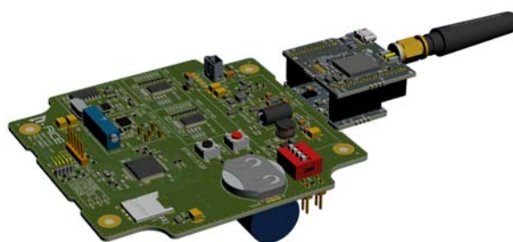
Obr. 3 Deska plošných spojů elektronické vyhodnocovací jednotky s modulem bezdrátového přenosu dat prostřednictvím LoRaWAN.
