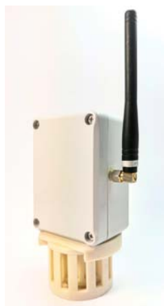
Obr. 1 Sensorový systém pro měření relativní vlhkosti a teploty mikroklimatu s bezdrátovou jednotkou pro přenos dat.
