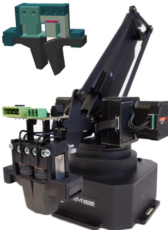
Funkční vzorek magnetického soft-robotického chapadla umístěný na robotickém manipulátoru a 3D vizualizace modelu konstrukce efektoru (miniatura).
