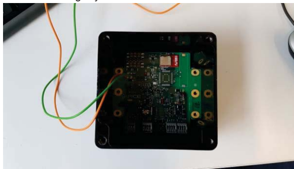
Obr. 2 HW speciálních IoT senzorů do výbušného prostředí
