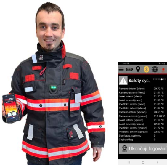
Obr. 1: Realizovaný ochranný hasičský zásahový oblek s integrovaným systémem včasného varování včetně softwarové aplikace.
