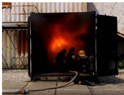
Obr. 3: Testování obleku v FOK na ohňovém polygonu ve Zbirohu.
