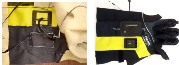
Obr. 4: Integrace hlavního elektronického a senzorového modulu do rukavice.
