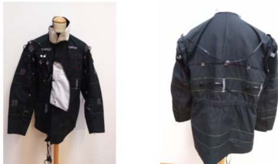
Obr. 2: Příklad integrace elektronických prvků do vnitřní vrstvy obleku včetně jejich propojení pomocí textilní sběrnice.
