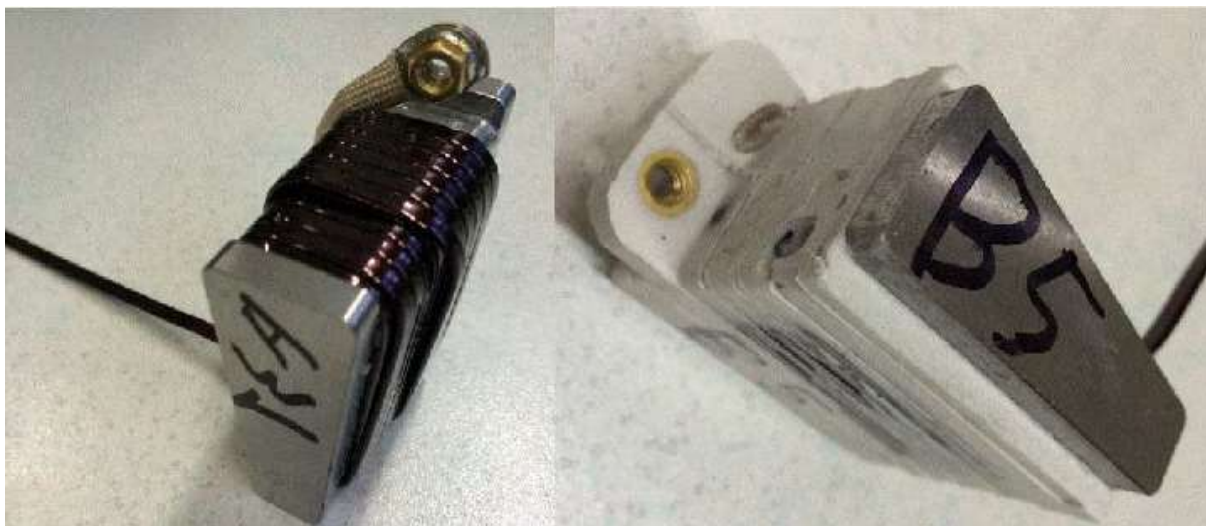
Obr. 30: Segment statoru před a po zalití do epoxidové pryskyřice [22]
