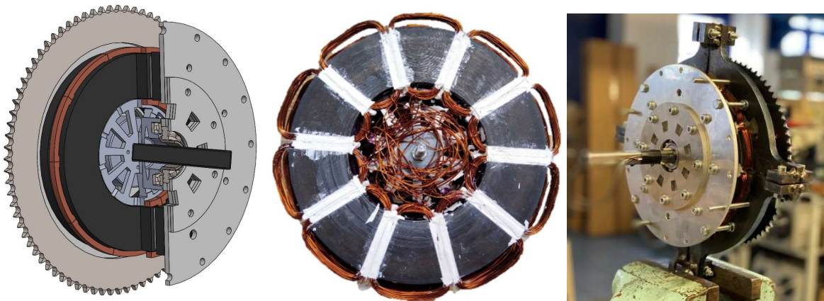
Obr. 55: Model a fotografie vzorku stroje s axiálním tokem [30]
