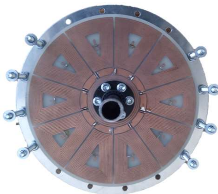
Obr. 39: Planární vinutí na frézované oboustranné DPS [30]
