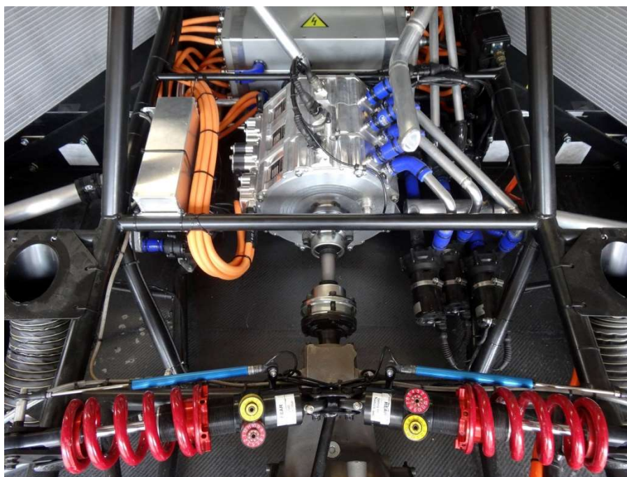
Obr. 27: Použití tří mechanicky spojených strojů YASA [19]
