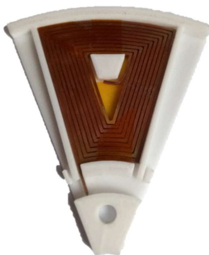
Obr. 37: Planární vinutí řezané laserem [30]
