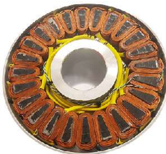
Obr. 33: Stator se zubovým vinutím [26]
