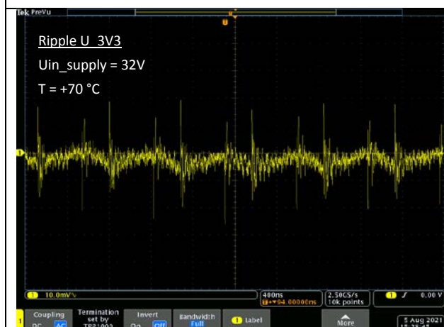
Obr. 6.11 Zvlnění U_3V3 při Uin_supply = 32V, Teplota +70 °C
