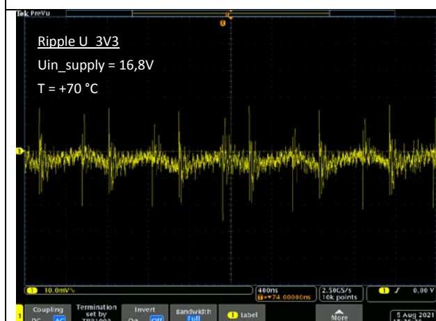
Obr. 6.9 Zvlnění U_3V3 při Uin_supply = 16,8V, Teplota +70 °C
