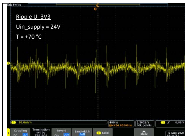
Obr. 6.7 Zvlnění U_3V3 při Uin_supply = 24V, Teplota +70 °C
